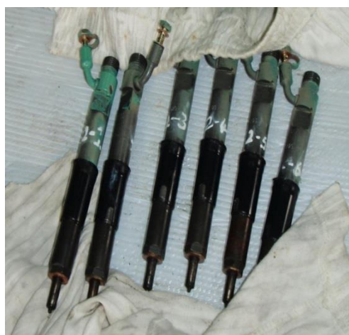
圖 1 柴油引擎更換機油及發電機組噴油嘴拆卸校正
